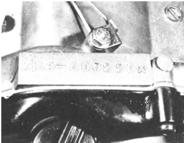
Bild 1: Anbringungsort der Motornummer
