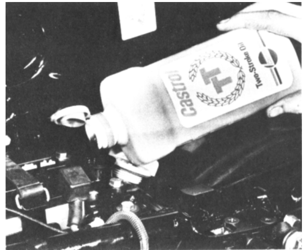
Bild 4: Es ist immer das richtige Zweitaktöl einzufüllen
