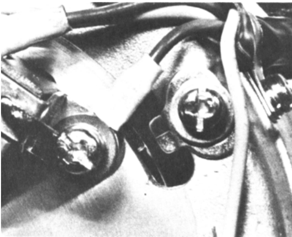
Bild 14: Der Zündzeitpunkt wird durch fluchten der aufgetragenen Markierungen ungefähr geprüft
