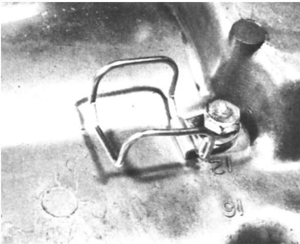
Bild 35: ... das Kabel aus der Klammer heben
