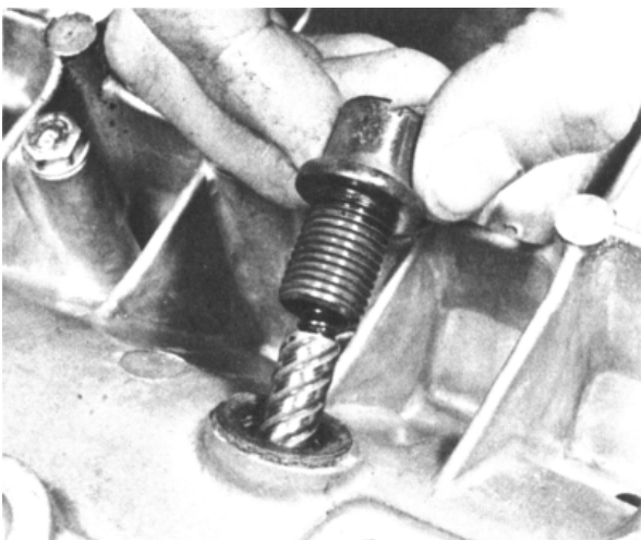
Bild 104: Die Nockenscheiben-Sperrvorrichtung wieder ins Kurbelgehäuse einbauen
