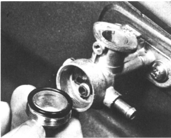
Bild 145: Der Schlammabscheider ist mit einem O-Ring abgedichtet
