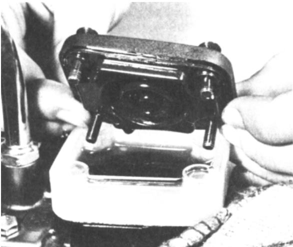
Bild 5: Der Ausgleichsbehälter-Deckel des Hauptbremszylinders der Vorderradbremse wird von vier Schrauben gehalten
