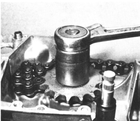
Bild 69: Das Kettenritzel zum Lösen der Mutter blockieren
