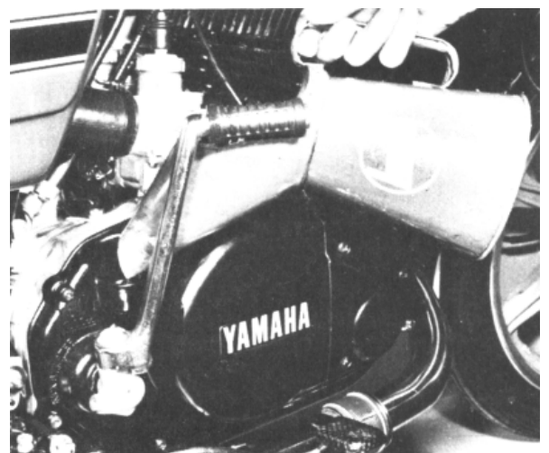
Bild 8: Erforderlichenfalls das Getriebeöl auf den richtigen Stand auffüllen
