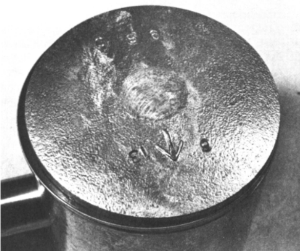
Bild 134: Jeden Kolben so einsetzen, dass das Pfeilzeichen nach vorne zeigt
