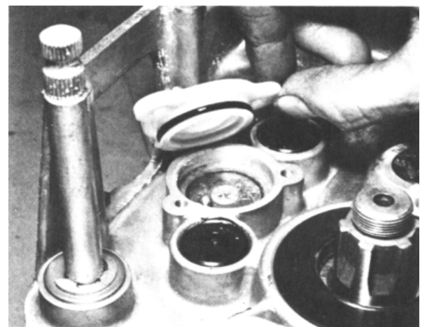
Bild 116: Der O-Ring darf auf dem Deckel für den Schalter der Leerlauf-Kontrollleuchte nicht vergessen werden
