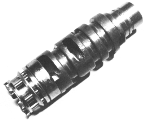
Bild 92: Die Führungen der Stahltrommel auf Verschleiss kontrollieren
