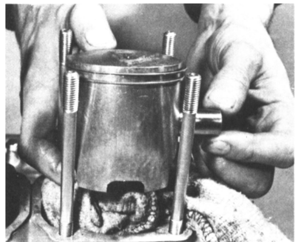
Bild 135: Den Kolbenbolzen einsetzen. Es sind immer neue Sicherungsringe zu benutzen
