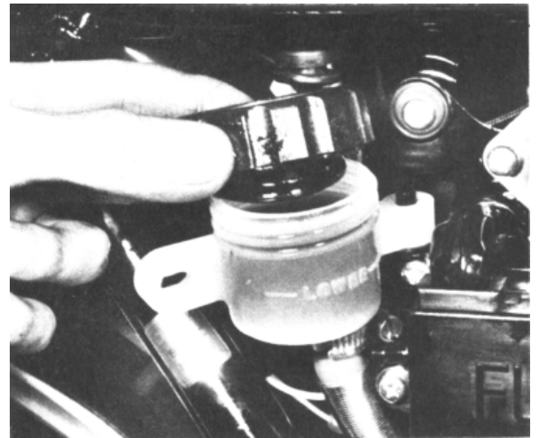
Bild 6: Den Vorratsbehälter des hinteren Hauptbremszylinders zum Abdrehen des Deckels nach aussen schwenken
