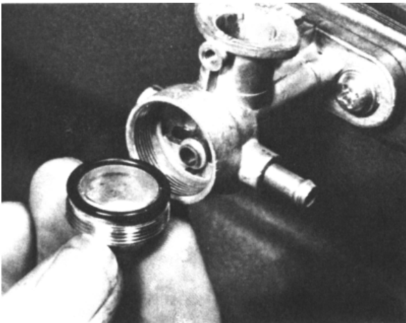
Bild 23: Zur Beseitigung der Ablagerungen den Schlammsammler des Kraftstoffhahns herausziehen
