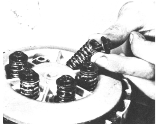
Bild 56: Die Kupplungsfedern und alle Platten abnehmen
