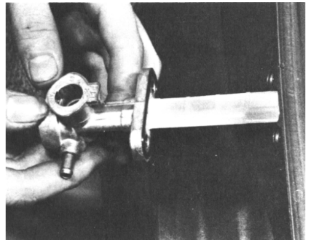
Bild 146: Der Hauptfilter ist im Kraftstoffbehälter untergebracht
